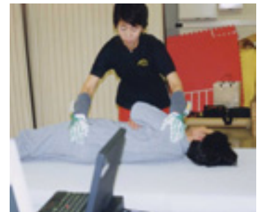
患者さんの身体の向きを変える時にかかる力を、筋電図と同時に測定している
